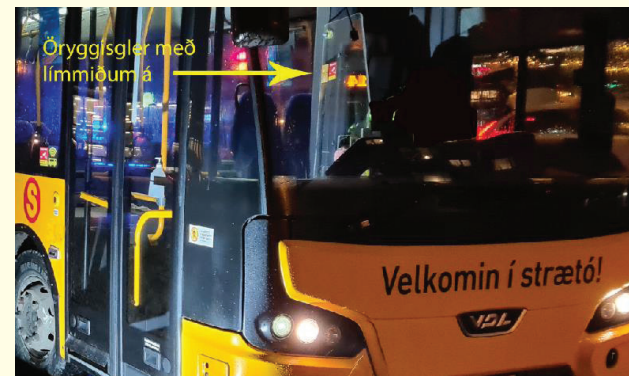
Öryggisgler, með tveimur limmiðum, við rými bílstjóra skilur hann frá farþegum sem koma inn í vagninn. Með þessu gleri er möguleiki á aukinni speglun í rými bílstjóra.
