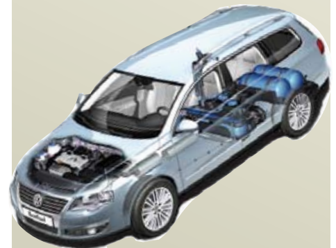
Eldsneytisgeymarnir eru sérstaklega hannaðir inn í burðarvirki bílsins.
