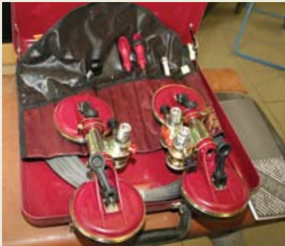
Eldri gerð tækja til að fjarlægja framrúður sjást á efri myndinni. Þau nýjustu eru mun öflugri. Tvær stórar sogskálar og vírspil eru á hvorum helmingi búnaðarins. Vírin skerst gegnum kíttid sem festir rúðuna við bílinn.
