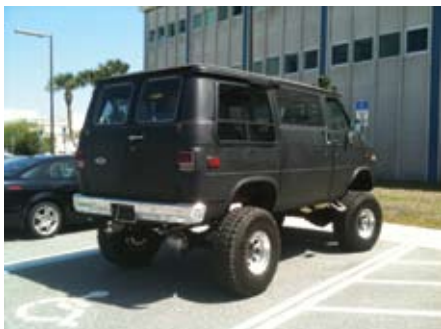
Breyttur og mjög upphækkaður Ford Econoline. Engar undirakstursvarnir eins og skylt er að hafa á vörubílum.
