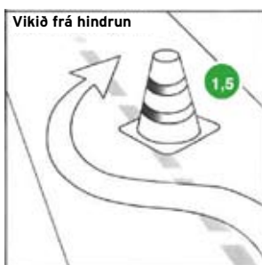
Elgspróf ADAC fer þannig fram að ekið er milli keilla á 90 km hraða. Með þessu er verið að líkja eftir því að verið sé að beygja framhjá t.d. manneskju.
