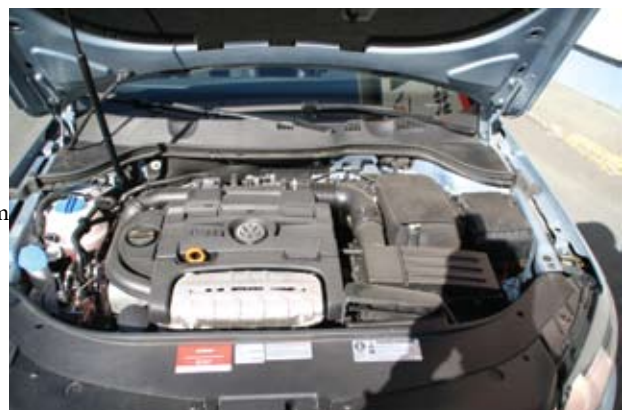
Vélin í þessum stóra bíl er einungis 1,4 l að rúmtaki en mjög öflug engu að síður.
