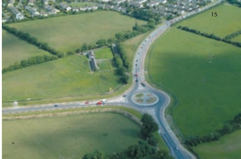
Þar sem vegir skerast þvert hvor á annan verða alvarlegustu árekstrarnir, hvort heldur sem umferðin er ljósstýrð eða annar vegurinn hefur forgang á hinn. Hringtorg draga stórlega úr hættu á vegamótum eins og sýnt hefur sig hér á landi, t.d. á Þjóðvegi 1 við Rauðavatn og við Hveragerði.
